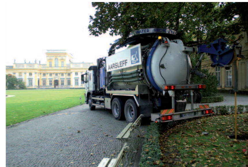
Czyszczenie kanalizacji za pomocą wozu ciśnieniowego.
